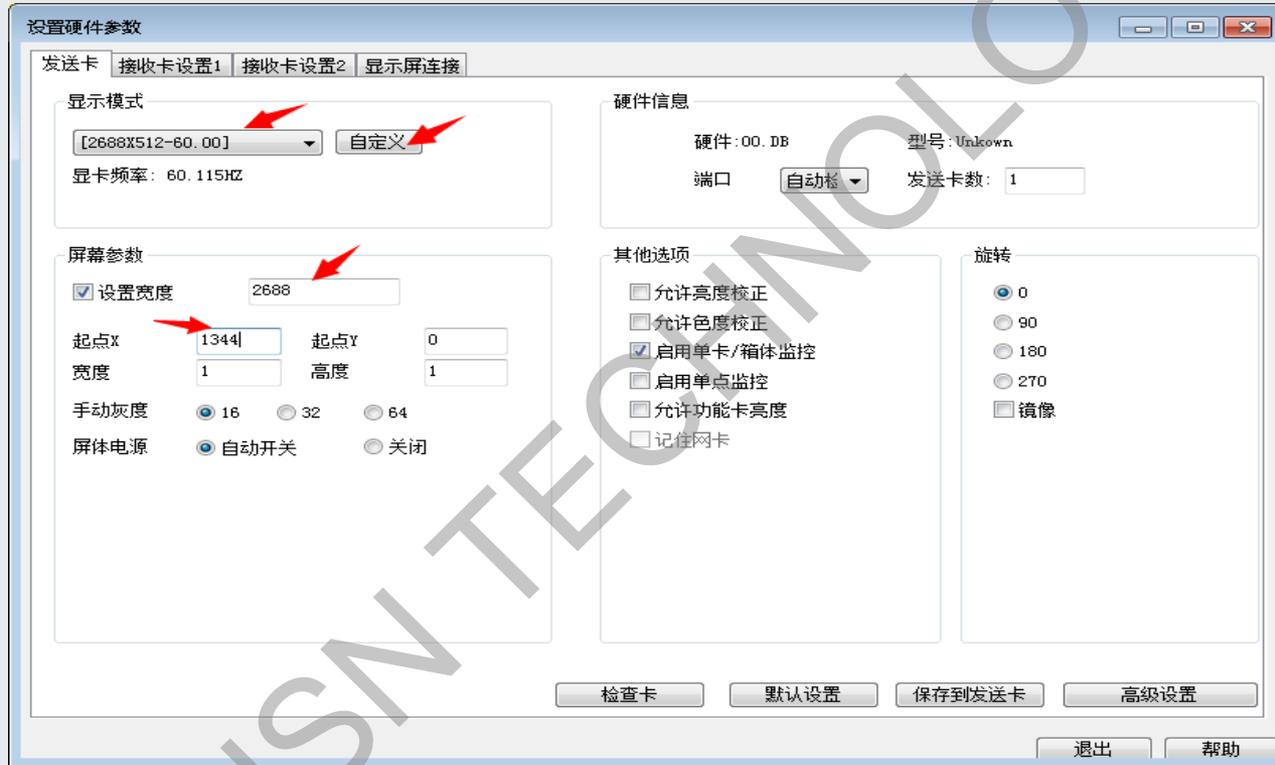
②在发送卡界面里设置整个大屏宽度，将设置宽度勾选上，填入大屏的宽度。
